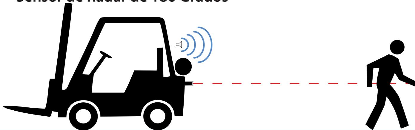
**Frecuencia de LED aumenta a medida que el sensor se acerca a obstrucción. El sensor desencadena luces LED y alarma audible opcional cuando el camino del sensor se interrumpe.**
